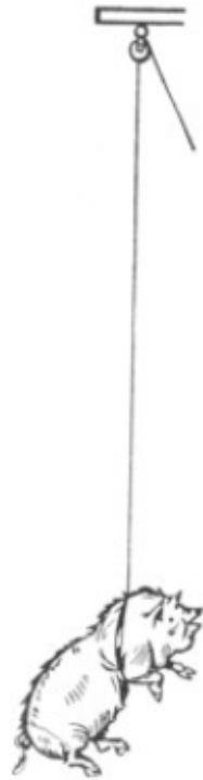
Figura 48. Un cable de acero de cromo-níquel aguanta una carga de 200 kg por \text{mm}^2
