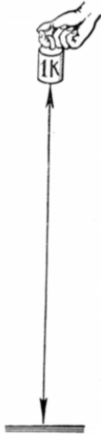
Figura 53. ¿Cómo se realiza un trabajo igual a un kilográmetro?
